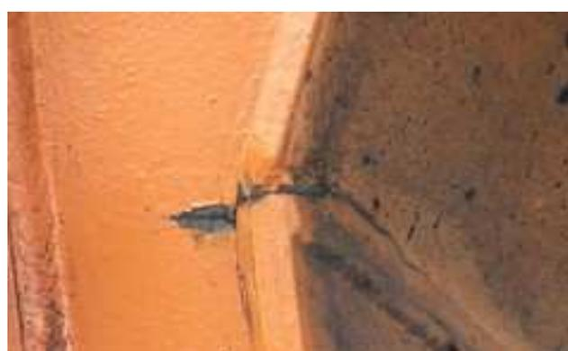
Fig. 4 – Cricca sulla saldatura di una gru su autocarro
