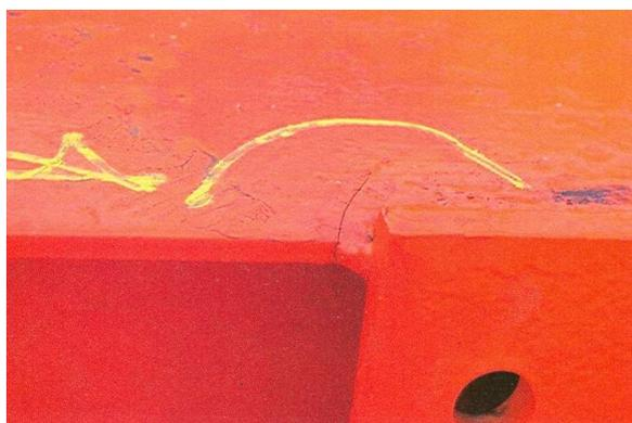
Fig. 3 – Cricca in corrispondenza della trave di testata di un carro ponte
