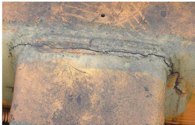
Fig. 2 – Cricca sulla saldatura di una autogrù
