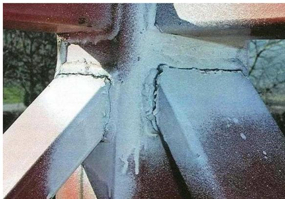
Fig. 1 – Saldature criccate sulla torre di una gru edile
